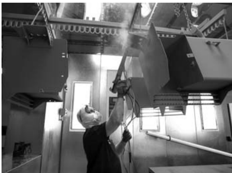
Un operario pinta una la pieza de una estructura metálica.
