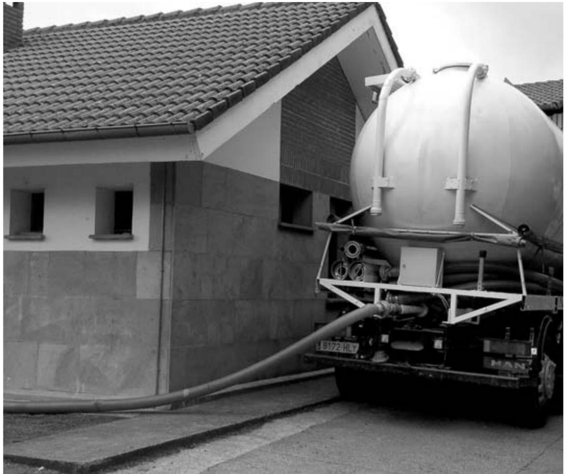
Una camión cisterna llena el tanque de gasóleo de calefacción de una vivienda de cara al frío.
