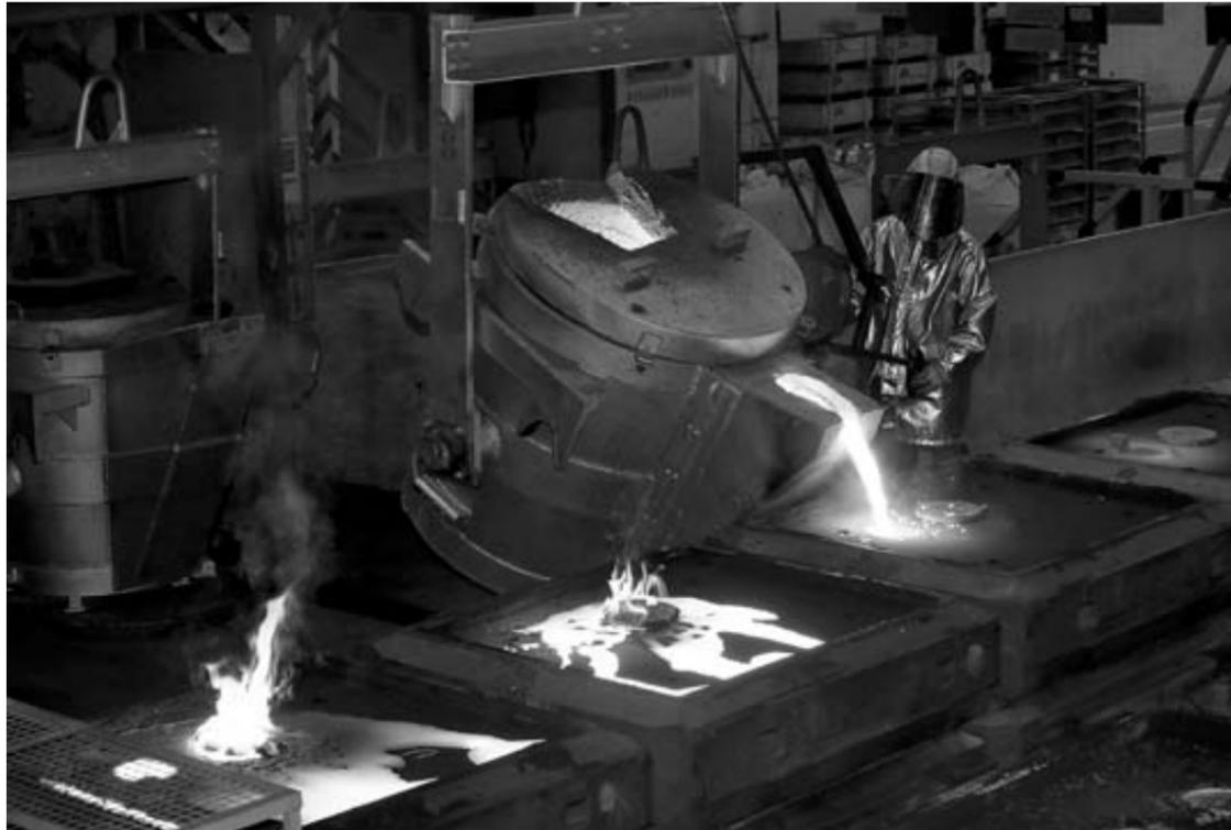
Un detalle del proceso de la colada, en la fundición que Magotteaux Navarra tiene en Urdiain. EDUARDO BUXENS
