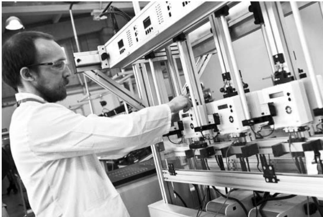
Un operario de General Electric monta un contador eléctrico inteligente.
