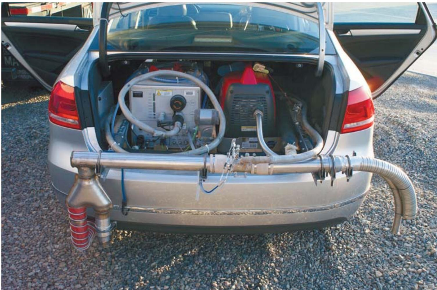
Imagen distribuida por la Universidad West Virginia con el equipo de medición de emisiones instalado en el Volkswagen Passat.
