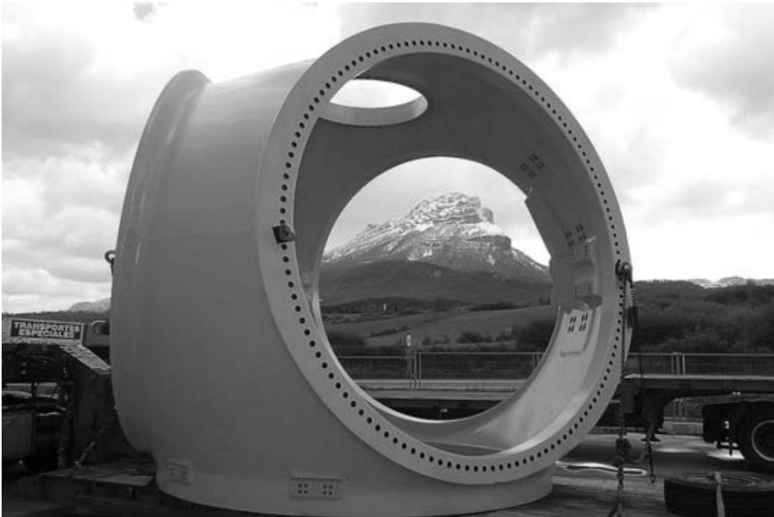
El buje o eje de sujeción de palas de aerogenerador, con la imagen de San Donato al fondo.
