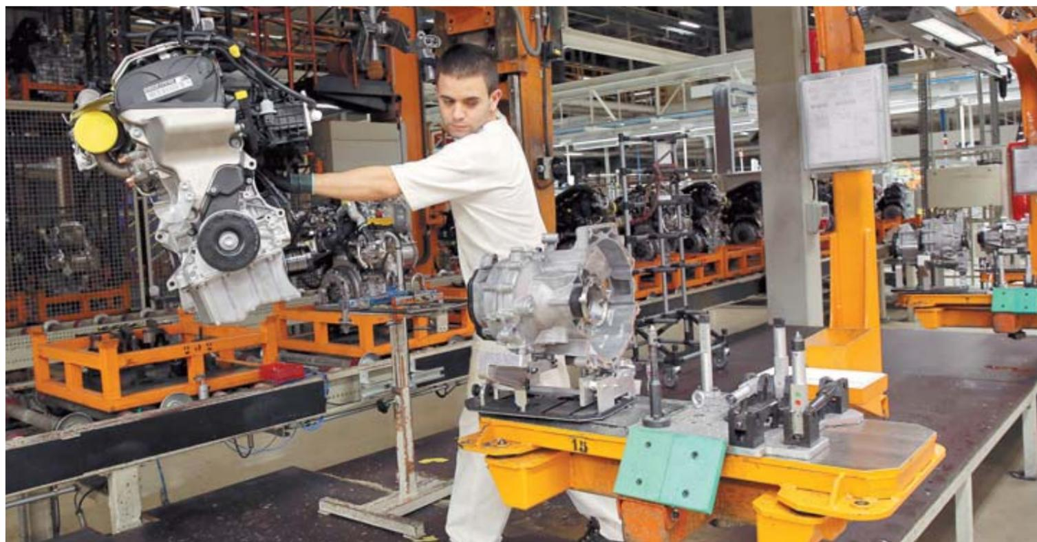
Un operario del taller de motores manipula uno de los bloques para ensamblarlo a la caja de cambios.
