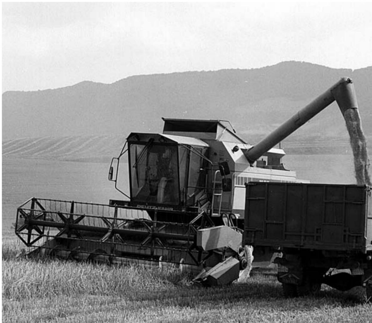
Una máquina cosechadora descarga el grano en un remolque para llevarlo a un silo.
