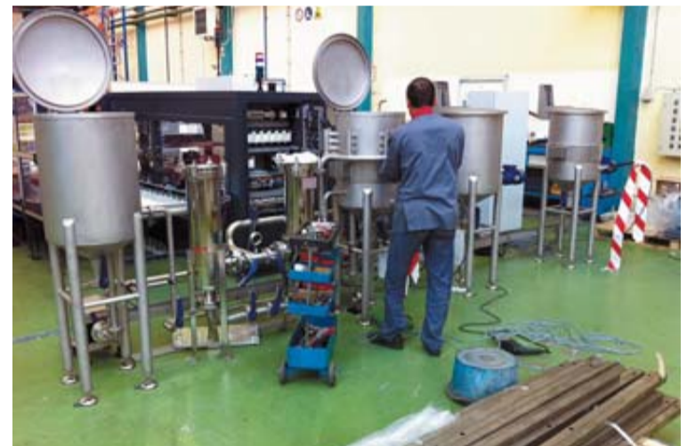
Una imagen del módulo de purificación del PVB de la planta piloto de Pamplona que se presentará en los próximos meses.
