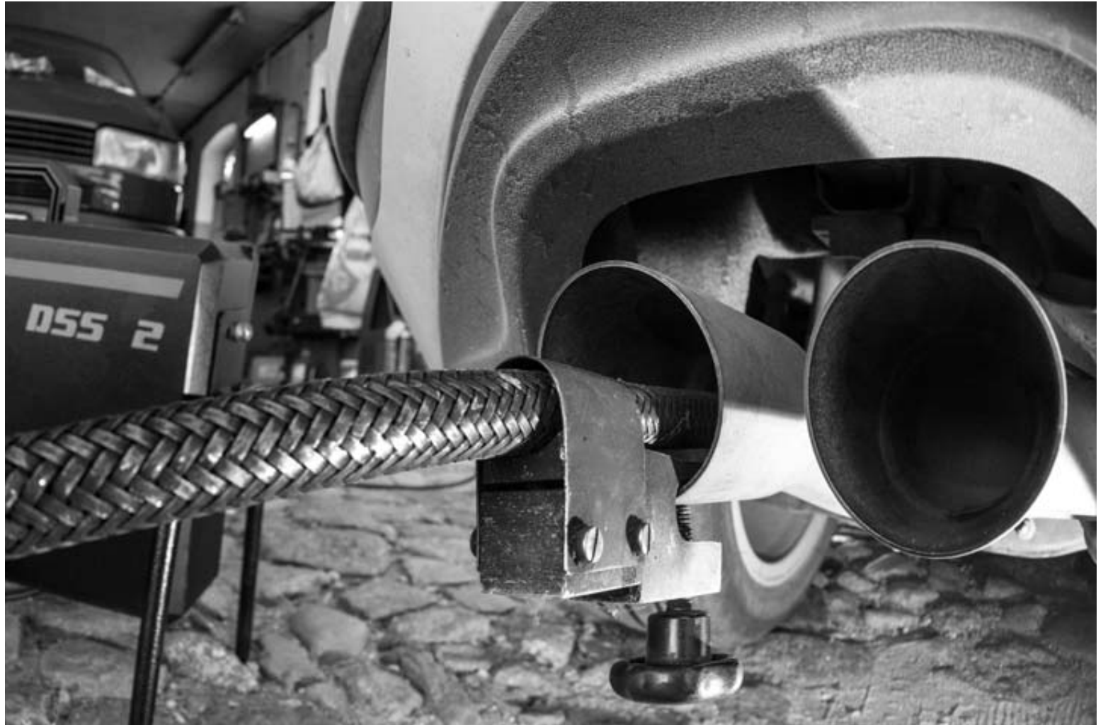
Un Volkswagen Golf se somete a pruebas de medición de emisiones en un garaje de Fráncfort.
