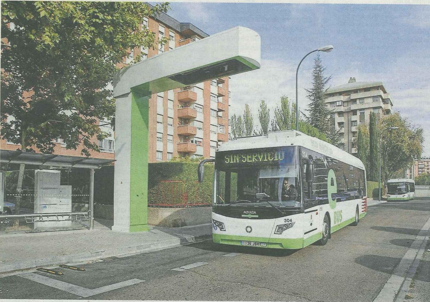
Un autobús eléctrico inteligente (BEI), de la compañía Vectia, junto a una batería de carga. Foto: archivo
