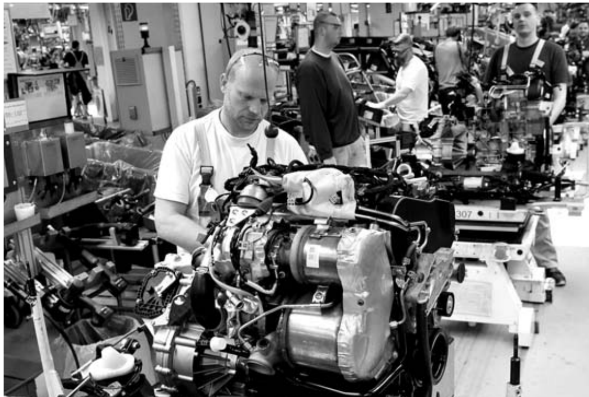
Cadena de montaje de los motores del E-Golf en la factoría de Wolfsburg.
