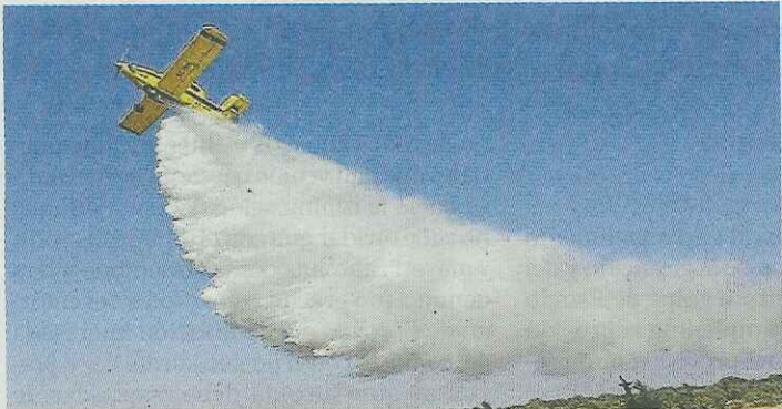
Un Air Tractor 802 realiza una descarga de agua. Foto: D.N.
