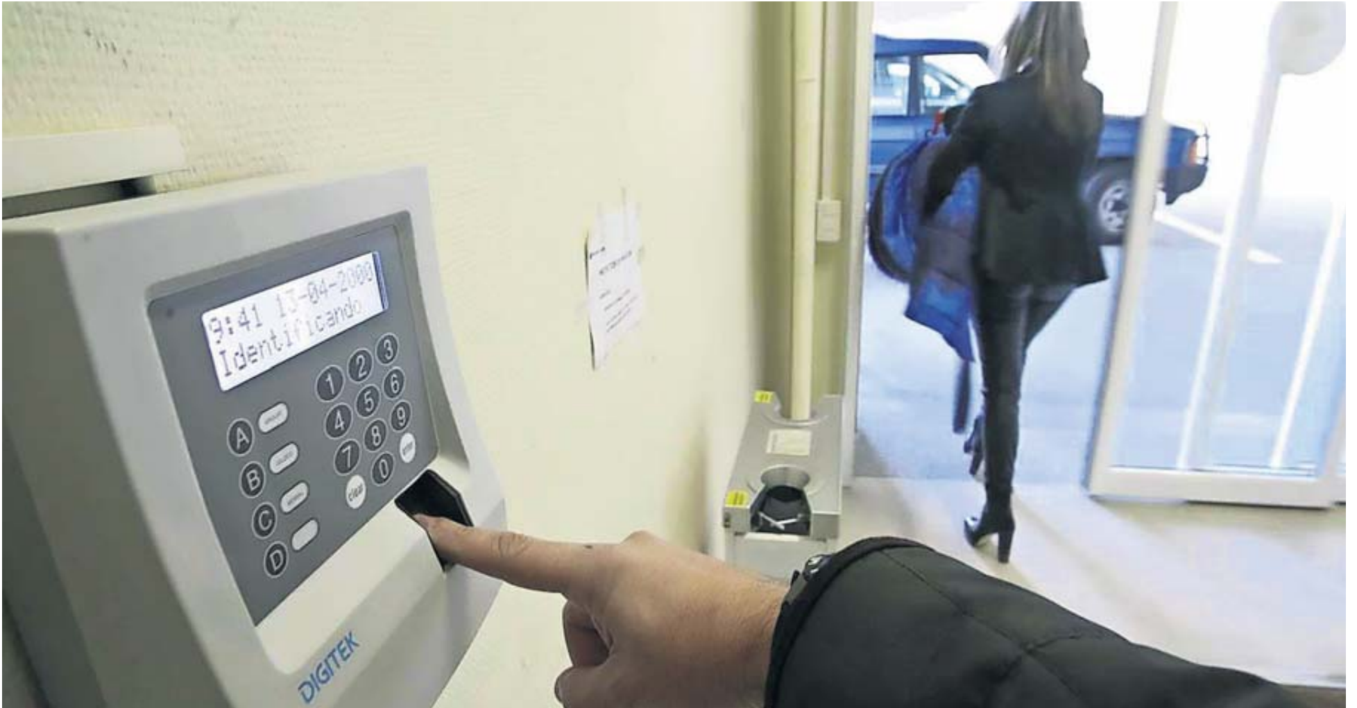
Imagen de una máquina que controla la entrada y salida de los trabajadores de un centro de trabajo mediante la huella dactilar.
