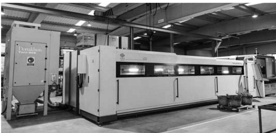
La nueva máquina láser, donde se cortan los tubos y planchas en piezas para montar los diferentes productos de mobiliario para personas con dificultad en movilidad. MONTXO A.G.
