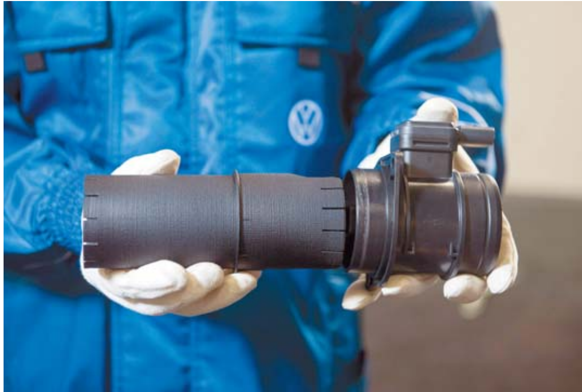
El convertidor de corriente que se instalará delante del caudalímetro del aire en los motores diésel 1.6. VW
