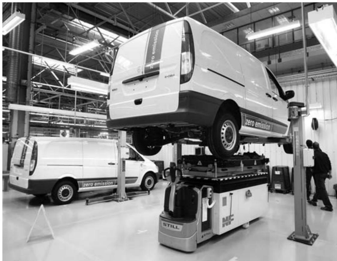
Montaje de baterías en furgonetas, en la fábrica de Mercedes en Vitoria.
