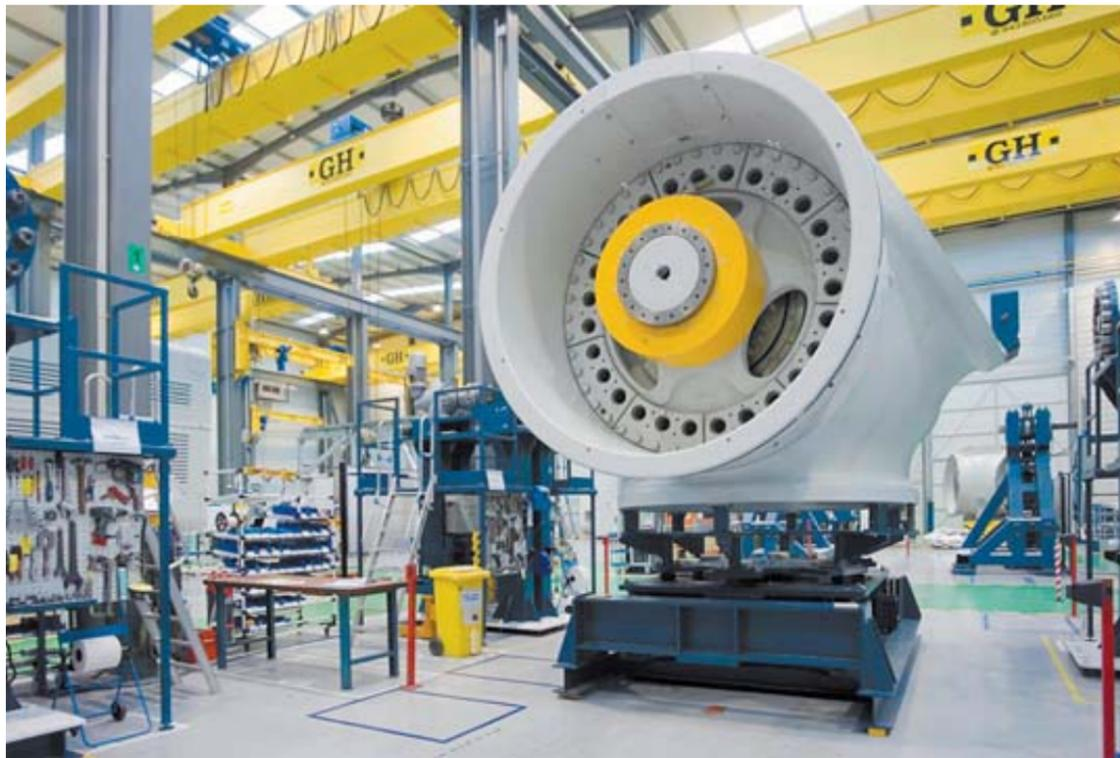
Imagen de una de las góndolas que se ensamblan en Buñuel para los aerogeneradores de Alstom.
