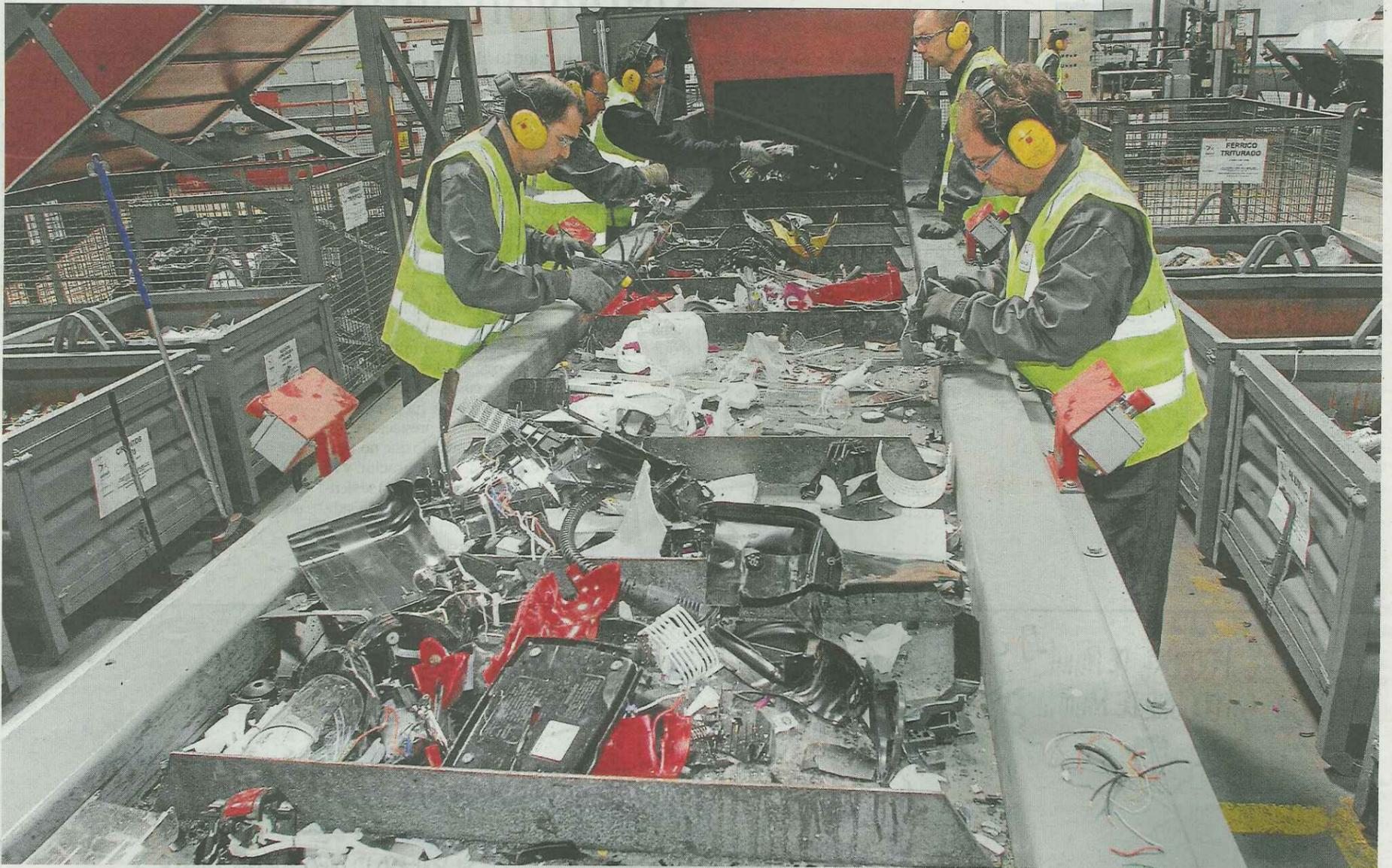
Trabajadores de una línea de tratamiento de restos de Residuos de Aparatos Eléctricos y Electrónicos (RAEE) en la planta Ecointegra de Aspace.
