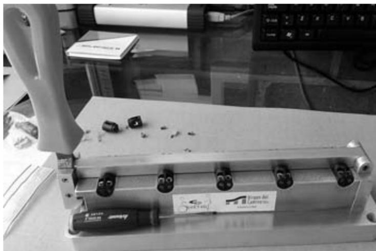
**El dispositivo diseñado por los alumnos facilita el montaje de pilotos led.** DN
