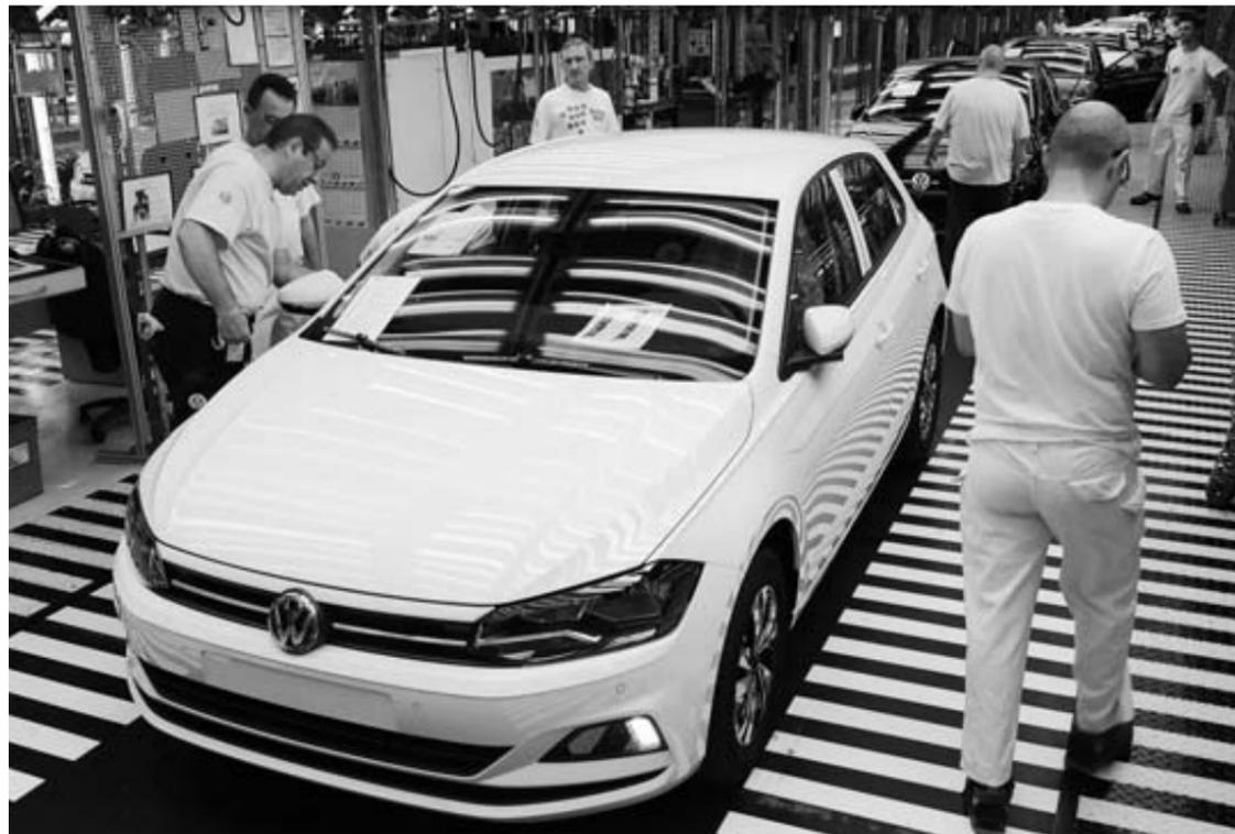
Operarios del taller de revisión final inspeccionan uno de las unidades recién fabricadas.
