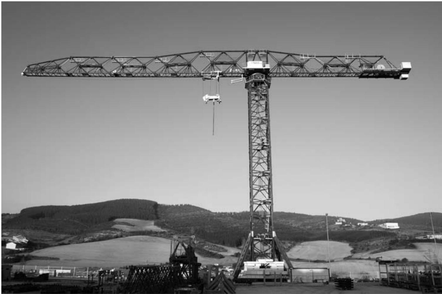
Imagen de la grúa-torre fabricada por Comansa, la mayor construida hasta ahora en España.
