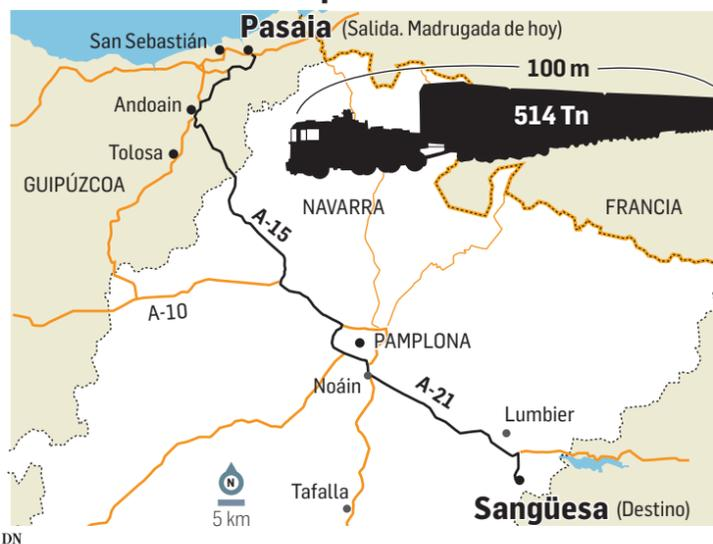
Las dimensiones de la carga quedan evidenciadas en los cien metros de longitud de la plataforma sobre la que quedará depositada. Los 94,81 metros de largo, 6,54 de ancho, 5,32 de alto y 514,4 toneladas de peso ralentizarán su movimiento, que absorberá la potencia de tres cabezas tractoras. Un cuarto vehículo circulará a corta distancia como apoyo. En un símil lo suficientemente ilustrativo de las medidas del conjunto rodante, la longitud de la plataforma equi-
